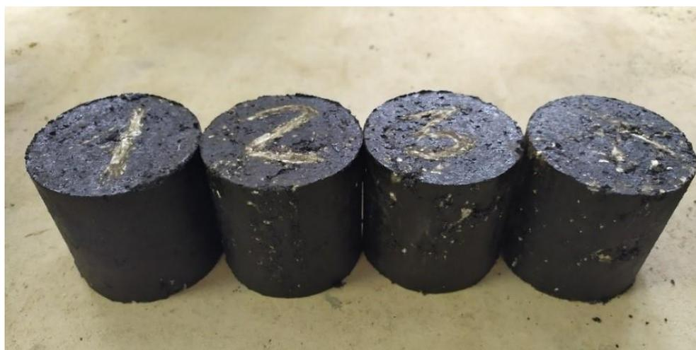
Рис. 5. Образцы, полученные при формовании органоминеральной смеси на основе нефтешлама
