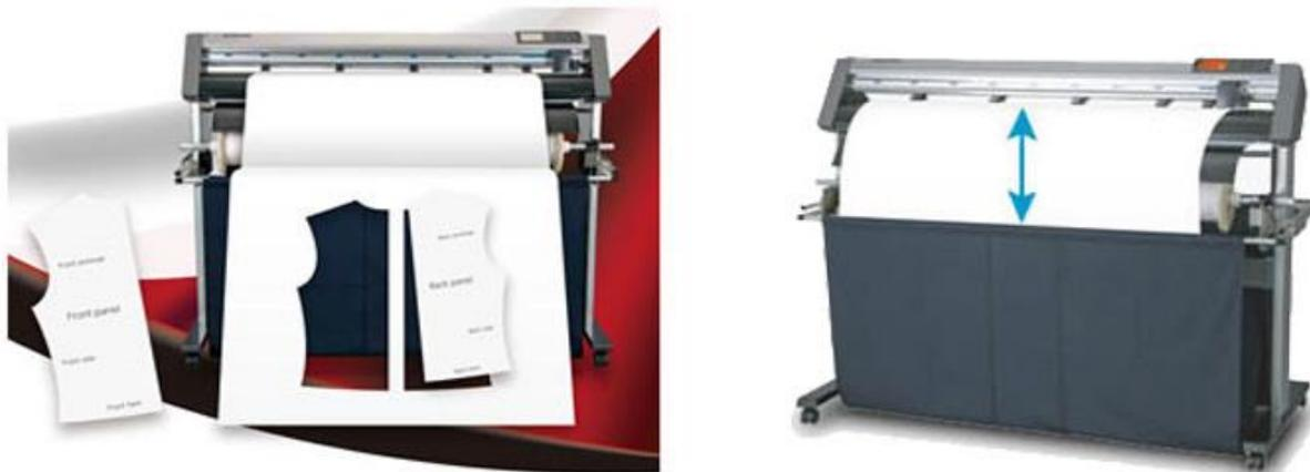
Рис. 2. Режущий плоттер для рисования и вырезки лекал (Graphtec CE7000-130AP)
