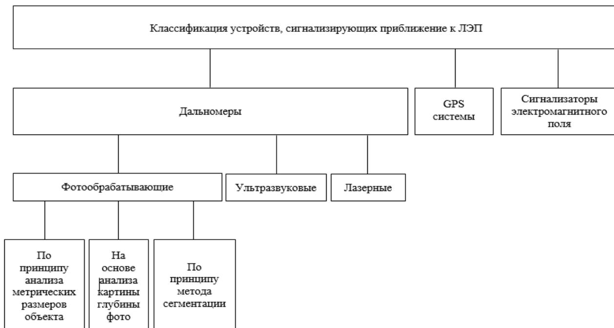
Рис. 2. Классификация устройств, сигнализирующих о приближении к ЛЭП
